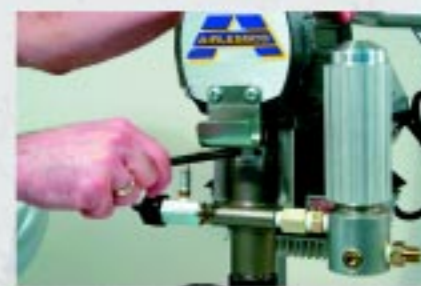
Uszczelka tłoka regulowana od zewnątrz.
